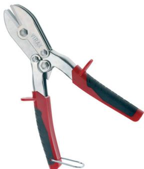
La pénétration des couteaux entre eux forme sur le pourtour du tuyau une ondulation qui diminue le diamètre et permet l'emboîtement aisé et régulier de tous les tuyaux (de fumée, d'évacuation de gaz, de ventilation, d'aspiration de poussières, de descente d'eau...).
