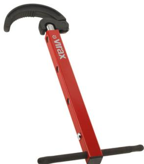
Clé lavabo télescopique 4 positions pour écrous ou raccords de lavabo, baignoire, évier ou bidet. Ensemble mors fixe et mâchoire mobile pivotant sur 180° à l'extrémité du manche. Ressort de rappel pour maintien de la mâchoire.
