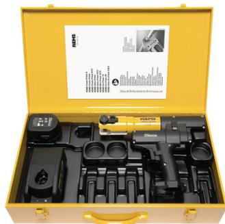
Avec marche forcée. Sertissage sûr et ultra-rapide. Répartition optimale du poids pour maniement à une main. Verrouillage automatique de la pince à sertir. Entraînement électrohydraulique avec moteur à accu 14,4V, 420W. Engrenage planétaire robuste. Pompe à piston excentrique et système hydraulique compact et puissant. interrupteur à bouton poussoir de sécurité. Lampe de travail à LED intégrée.
