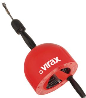
Déboucheur manuel pour canalisations Ø25-75mm. Livré avec câble à âme acier Ø7mm/7,5m, flexible et résistant, pour Ø25-50mm. Vrille articulée pour passage facilité dans les coudes. Maniable (seulement 2,7kg). Utilisable avec perceuse (non fournie).
