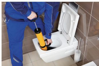
Déboucheur à pompe robuste et ergonomique pour éliminer rapidement les bouchons. Grande force de pression grâce à la poignée avant réglable. Equipement selon la nature des travaux de débouchage grâce à 2 manchons : un manchon court pour les éviers et les lavabos, un manchon long pour les toilettes.
