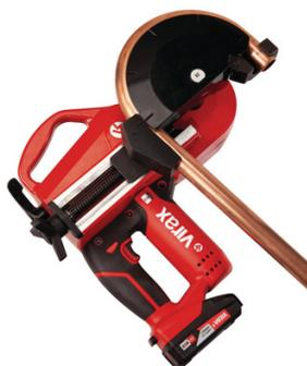
Réglage précis de la contre-forme : serrage et maintien optimisés du tube lors du cintrage pour réaliser des cintres de grande qualité. Batterie CAS compatible et performante : technologie Lithium-Ion 18V compatible avec plus de 300 machines des partenaires de l'alliance CAS (Cordless Alliance System). Idéal pour coude dans coude rapprochés. Diamètre : Forme = 12 - 14 - 16 - 18 - 22 mm - Contre forme = 12/15 - 14/16 - 18/22 mm
