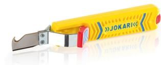
Matière : bi-matière. Lame de coupe traitée au Nitrure de Titane pour une plus grande longévité. Profondeur de coupe réglable. Ajustage automatique de la lame pour coupe longitudinale. Contient une lame de rechange.
