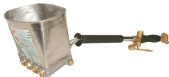
Type 2 mains. Godet 4 litres en tôle galvanisée avec 4 buses d'air démontables et 4 buses produits interchangeables Ø 1,5 ou 2 cm. Poignée ergonomique avec revêtement isolant en caoutchouc. Manche 55 cm. Godet 4 litres en tôle galvanisée. 4 buses d'air démontables. 4 buses produits Ø 2 cm. Kit de nettoyage. Raccord express et raccord rapide gros débit. Bonne prise en main (prise à deux mains). Facile d'utilisation et d'entretien. Rendement élevé 40 à 50 m<sup>2</sup>/h.
