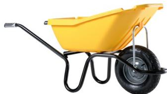
Caisse polypro jaune 110 L. Châssis CP2i® tube peint Ø 32 mm, ergonomique et indéformable, avec support caisse galvanisé. Roue gonflée Ø 400 mm (PF 154), jante métal flasque. Poignées bi-matières. Brouette idéale pour les travaux de jardinage et de bricolage. Brouette étroite et profonde, passe par toutes les portes.
