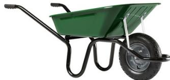
Caisse peinte 100 L, épaisseur 0,9 mm. Châssis CP2i® tube peint Ø 32 mm, ergonomique et indéformable, avec supports caisse. Roue gonflée Ø 380 mm (PF 150), jante métal flasque. Poignées ergonomiques. Brouette pour tous types de travaux. Châssis CP2i® ergonomique et indéformable.
