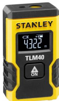
Portée de 12 m avec une précision de +/- 6 mm. Compact et léger, le TLM40 POCKET fonctionne sur batterie Li-Ion. Fonctions : prises de mesures directes et en continu.
