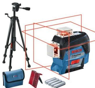
Possibilité de commande à distance depuis un smartphone avec l'application mobile basée sur Bluetooth®. 3 lignes laser sur 360° permettant d'effectuer simultanément des mises à niveau horizontales et verticales pour un maximum d'efficacité. Température de service : de -10 à 40°C. Livré avec un trépied BT150 et un lot de 4 piles AA.
