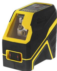
Niveau croix polyvalent, portée 15 m (50 m avec cellule). Diode laser : Classe 2 : 620-680 nm. Précision : +/- 3 mm @ 10 m. Plage de nivellement : +/-4°.
