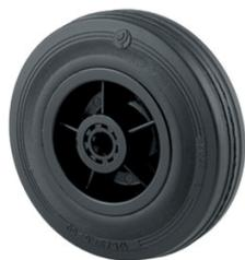
Corps de roue polypropylène, bandage : caoutchouc semi-élastique noir. Dureté Shore du bandage : 85A. PVO : moyeu lisse - PVR : roulements rouleaux. Capacité de charge : 135 kg.
