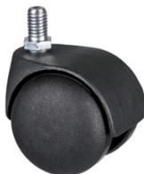
Roulette pour tables et bureaux. Fixation par tige filetée. Moyeu lisse. Charge : 40 kg. Diamètre de la roue : 50 mm. Frein : Non. Hauteur : 59 mm. Largeur bande de roulement : 8 mm. Largeur de la roulette : 55 mm. Rayon d'encombrement : 49 mm. Roulement : Roulements lisses. Résistance à la température : - 10 / + 40 °C.
