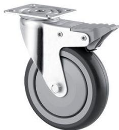
Roulette en acier embouti, finition zinguée, version pivotante avec pivot sur double chemin de billes. Fixation à platine. Corps de roue polypropylène, bandage : caoutchouc thermoplastique non tachant, avec pare-fils, roulements à billes de précision. Dureté Shore du bandage : 87A. Diamètre platine : 77 x 67 mm. Largueur de bandage : 32 mm. Diamètre du trou : 8,5 mm. Entre axes : 61,5/56 x 51,5/46,5.
