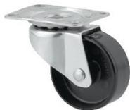
Roulette de quincaillerie en acier embouti, finition zinguée, version pivotante. Corps de roue en polypropylène ou polyuréthane. Dureté Shore du bandage : 1430POI : 65D. Diamètre platine : 59 x 47. Entre axe : 46 x 35 mm. Diamètre des trous : 6,7 mm.
