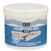
Décapant pour soudure à l'étain - contact eau potable. Sans acide ni chlorure agressif pour les matériaux et les utilisateurs. Brasage tendre des métaux courants : cuivre, bronze, laiton, étain, zinc neuf, plomb sauf alu acier inoxydable. Formulé à partir de matières autorisées au contact de l'eau potable.
