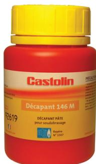
Décapant en pâte pour les métaux cuivreux et ferreux. Destiné pour le soudobrasage. Composition constituée d'un mélange de borates alcalins sans acide borique destinée à l'assemblage à la flamme du cuivre, des aciers et de la fonte. ATG N°1567 en combinaison avec la baguette 146Gaz. Spécial Plomberie.
