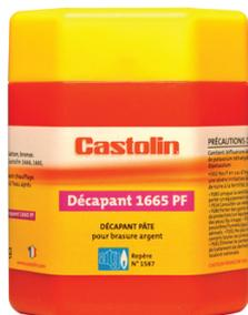
Le décapant en pâte constitue d'un mélange de sels complexes de potassium, borates et fluoborates. Il est destiné au brasage capillaire de l'acier, cuivre, laiton et bronze à l'aide d'alliages à haute teneur en argent. Produit sans acide borique ou borax. Certifié ATG n°1587. A utiliser pour les alliages argent et la 1665 GAZ.
