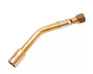
Lances aéro-gaz à flamme dard. Modulation de la température de flamme de 1200 à  $1850^{\circ}$ C à l'aide de leur bague d'air. Polyvalence totale en utilisant un détendeur. Réglage très fin.
