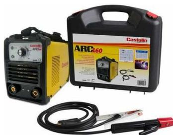
Poste onduleur compact et léger, monophasé pour le soudage à l'électrode enrobée. Livré dans une valise avec câble de masse et porte électrode. Facteur de marche à 40°C : 35% 160A, 60% 95A, 100% 70A. Norme : EN 60974-1. Temps de charge : 65 minutes.
