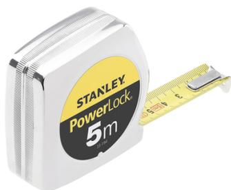
Revêtement Mylar haute protection et anti-abrasion sur la totalité du ruban : durée de vie multipliée par 10 par rapport à un ruban traditionnel. Boîtier ABS finition métal chromé très résistant aux chocs et à la flamme. Blocage du ruban et retour automatique. Mesure intérieure par addition de 5 cm. Crochet 3 rivets offrant une bonne résistance à l'arrachement. Crochet avec position du zéro réel : pour mesures intérieures et extérieures. Agrafe pour port à la ceinture.
