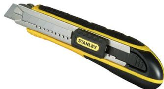
Corps ABS bimatière pour une bonne prise en main. Chariot de lame en acier inoxydable : longévité et guidage parfait de la lame. Double sécurité avec le blocage supplémentaire par curseur pour un maintien parfait de la lame. Casse-lames intégré : pour casser les lames de manière sûre et efficace. Cartouche de 6 lames à rechargement automatique. Fourni avec 6 lames de cutter 18 mm FatMax.
