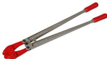
Bras forgés pour une résistance parfaite aux conditions extrêmes des chantiers. Poignée gainée. Réglage rapide de l'écartement de la lame avec une seule vis. Lames forgées indéformables et assemblées par rivetage. Coupe tous les types de profils.
