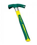
Acier au carbone trempé et revenu. Poignée tri-matière ergonomique anti-glissement, confort de la prise en main. Partie inférieure du manche évasée, anti-échappement. Aimant porte-clou, pointer d'une main sans tenir le clou. Surfaces de frappe latérales, pointer dans les espaces réduits. Arêtes supérieures vives : racler les résidus de béton. Extrémité du manche en polymère dur, ajuster les matériaux sans les abîmer.
