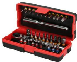
Entraînement 6 pans 1/4" selon DIN 3126 / ISO 1173 - C 6,3. Pour une utilisation manuelle ou avec visseuse. Embouts avec code couleur. Cliquet réversible 72 dents. Tête inclinable à 180°. Avec rallonge et adaptateur 1/4". La rallonge peut aussi être utilisée comme poignée en T. Chromé satiné mat. Chrome Vanadium. Coffret de rangement bi-matière.
