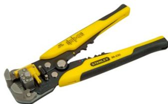
Equipée de mors à sertir les cosses et d'un coupe fil. Corps robuste en acier. Branches bi matière striées antidérapantes Soft Touch. Ressort de rappel. Réglage fin de la pression des mors grâce à la molette de serrage. La pince ajuste ses mors automatiquement au diamètre du fil. Possibilité de dénuder des fils de diamètre 0,2 à 6mm<sup>2</sup>. Réglage de la longueur de fil à dénuder de 6 à 18 mm
