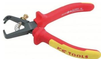
Pour conducteurs unifilaires, multifilaires et fils fins, isolation plastique ou caoutchouc diam. max. 5,0 mm et section 10 mm<sup>2</sup>. Réglage simple du diamètre du câble ou du fil grâce à l'écrou moleté et au contre-écrou. Acier à outils spécial, forgé, trempé à l'huile.
