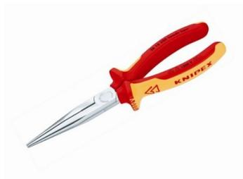
Pointes élastiques : indéformables, même soumises à la torsion. Pointes de précision élastiques et supportant la torsion. Mâchoires demi-rondes, longues et effilées. Avec tranchants (dureté env. 61 HRC) pour fils doux, mi-durs et durs. Acier électrique au vanadium, forgé, trempé à l'huile en plusieurs phases.
