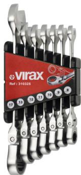
Tête flexible à 180° et fourche avec un angle de 15°. Clé à cliquet avec un angle de reprise de 5°. ?il à profil 12 pans : mise en place facile sur l'écrou. Clé idéale pour les serrages dans les endroits difficiles d'accès. Le jeu contient les dimensions les plus couramment utilisées : 8, 9, 10, 11, 12, 13 et 17 mm. Livrées dans un étui de rangement. Dimensions indiquées sur l'étui, permettant une sélection rapide et un rangement facile.
