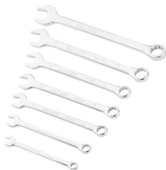
7 clés mixtes FatMax : 8 ? 10 ? 12 ? 13 ? 14 ? 17 ? 19 mm. Fourche et oeil orientés à 15° pour un meilleur accès. Système « anti slip » sur la fourche et prise de l'écrou sur 3 points pour améliorer l'adhérence de la fourche sur la tête de vis. Finition chrome mat pour une meilleure résistance à la corrosion. Etui compact pour rangement/visualisation facile des clés, les clés ne sont pas en vrac !
