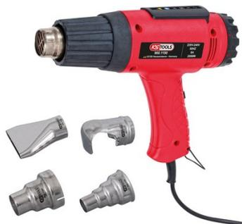
Décapeur thermique à 2 positions. Réglage de la température par molette. 6 plages de 50° à 650°C. Livré avec 4 buses différentes. Utilisation : pour détacher peintures et laques, soudage et brasage avec différents matériaux.
