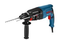
Perforateur SDS plus polyvalent et performant pour un usage au quotidien. Force de frappe de 2,7 J pour une progression de perçage rapide et une capacité de burinage élevée. Composants de grande qualité pour une grande robustesse, fiabilité et durée de vie. Mode burinage activable séparément pour une grande variété d?applications. Livré en coffret LBOXX. Filaire
