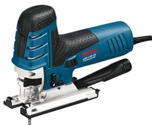
Mouvement pendulaire réglable sur 4 positions pour choisir le meilleur compromis vitesse / qualité pour votre application. Raccord pour aspiration de la poussière avec aspirateur. Plaque de base robuste en aluminium avec inserts en acier. Coupe aluminium : 20 mm / Coupe bois : 150 mm / Coupe métaux : 10 mm. Longueur du câble : 4 m. Filaire
