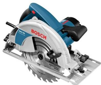
Une scie circulaire très puissante (capacité de coupe de 85 mm) et compatible avec les rails de guidage. Moteur ultraperformant de 2 200 W permettant une capacité de coupe de 85 mm. Découpes rectilignes de grande longueur particulièrement précises grâce à la compatibilité avec le système de rails de guidage Bosch. Meilleure vision du tracé en permanence grâce à un déflecteur de copeaux optimisé et une soufflerie turbo.
