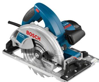
Moteur à régulation électronique de 1600 W. Vitesse de rotation à vide : 5900 tr/mn. Alésage : Ø 30 mm. Lame : Ø 190 mm. Profondeur de coupe 90°/45° : 65/48 mm. Poids : 5,2 kg. Vendu en coffret L-BOXX 238 avec : lame, adaptateur d'aspiration, clé mâle six pans 5 mm. Bois : 48 mm (45°) - 65 mm (90°). Filaire
