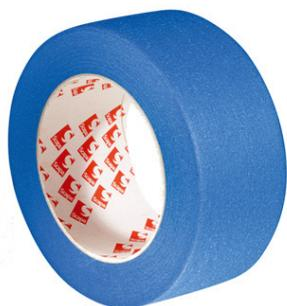
Scapa 9080B est un ruban semi-crêpe de 0,13 mm recouvert d'un système adhésif acrylique résistant aux rayons ultraviolets pour une utilisation intérieure et extérieure. Scapa 9080B est une application de 30 jours et résiste jusqu'à 80°C
