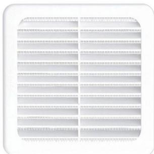
Permet de rejeter l'air vicié d'une habitation. Fabriquée en PVC renforcé, elle convient à une pose en extérieur comme en intérieur. - Dimensions d'encastrement : 100 x 100 mm. Passage d'air : 28 cm<sup>2</sup>.
