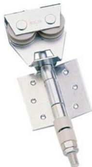
Capacité / Panneau : 50 kg. Rail : Profilé 40x6. Déplacement : Latéral. Le ressort de la monture permet une répartition uniforme des charges. Possibilité de réaliser une porte avec portillon.
