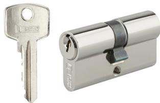
Cylindre de sûreté profil européen. Goupilles en laiton. Corps laiton massif. Ressorts en acier. Panneton en acier 30°. 3 clés plates en acier nickelé. Livré sur combinaisons variées. Dimensions de 60 à 120 mm (de 5 en 5 mm). Livré avec vis de fixation.
