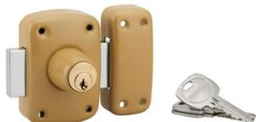
Verrou Cylindre double entrée. Verrou pour porte d'entrée vitrée. Hauteur du coffre 90 mm. Largeur du coffre 60 mm. Cylindre Diamètre 23 mm. Cylindre Longueur 40 mm. Cylindre. Laiton à 5 goupilles. 3 Clés Plates crantées.
