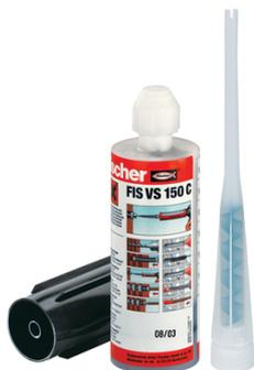
S'utilise avec un pistolet standard. 1er système à injection homologué pour tous les principaux matériaux de construction. Capacités de charges élevées pour plus de sécurité. Fixation sans contrainte d'expansion pour des distances aux bords et entraxes réduits. Temps de prise rallongé évitant le durcissement prématuré de la résine en cas de températures élevées et convient idéalement pour les profondeurs de forage importantes.
