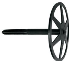
Effort de perçage réduit : la géométrie optimisée diminue la profondeur d'ancrage. Pression constante grâce aux nervures flexibles dans la zone du disque. Le montage simple au marteau économise temps et argent. Sa couleur la rend invisible sur les panneaux d'isolant noirs.
