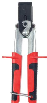
Permet d'expanser les chevilles métalliques pour corps creux HM. Conception robuste et stable. Poignée ergonomique pour une utilisation sans effort. Expansion directe dans l'axe du trou. Ressort de rappel.
