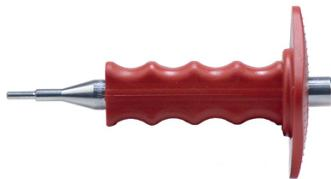
Outil manuel de pose de chevilles à frappe pour le montage sûr et conforme à l'homologation des chevilles EA II. La protection sur le manche protège l'utilisateur contre les blessures aux mains lors de la frappe de la cheville. L'outil de pose sert à élargir la douille d'ancrage contre les parois ou le béton.
