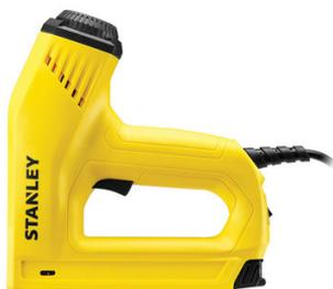
Utilisation régulière et intensive. Pour des agrafes type G de 6 à 14mm et clous J avec tête 12 à 15 mm. Puissance de frappe réglable selon le type de matériaux. Chargement à glissière pour un chargement facile et simple des agrafes et des clous. Système anti-bourrage. Longueur du câble 2,4 m.
