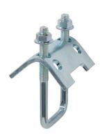
La griffe à poutrelle fischer TKR 31 convient pour la fixation de tubes et de rails directement sur des poutrelles en acier. La TKR 31 peut être fixée sur toutes les poutrelles en acier standard. Aucun perçage ni soudure ne sont nécessaires pour la fixation. Les griffes à poutrelles peuvent être démontées. La version électrozinguée convient pour l'installation dans les bâtiments.
