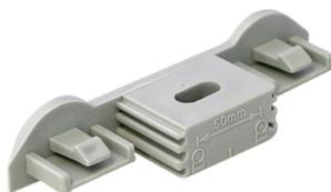
Fixation de deux tubes avec des colliers starQuick® jusqu'à SQ-20 (éventuellement de diamètres différents). La distance entre le tuyau et le mur est la même que la distance entre le collier et le mur sans l'utilisation de la plaque murale matière : PA6 (polyamide) modifié gris ou blanc, résistant aux UV, au vieillissement, à l'huile et à l'essence, pas de corrosion, recyclable, sans halogène, température d'utilisation : de -40°C à +90°C ; température de montage jusqu'à +130°C
