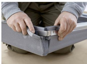
Le bloc isolant BDX 0000 de Velux se compose d'une mousse isolante collée sur un précadre en acier galvanisé. Il se pose en périphérie de fenêtre et permet de réduire les ponts thermiques entre le chevêtre et le dormant.
